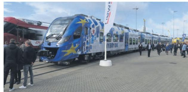
Dieser Triebwagen von der polnischen Firma NEWAG kann man als Elektrotriebwagen, mit Dieselantrieb und mit Dual-Mode bestellen. In puncto Inneneinrichtung kann der Kunde zwischen Bestuhlung für Nah- und Fernverkehr wählen. Die Höchstgeschwindigkeit liegt bei 160 km/h bei Oberleitungsbetrieb und 130 km/h bei der Fahrt mit Dieselmotor.
