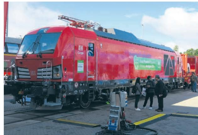
Auch die Siemens Vectron gibt es als Dual-Güterzuglokomotive, wenn auch mit lediglich einer Leistung von 2.400 kW bei elektrischem Betrieb und 2.000 kW im Dieselmotor. Die Höchstgeschwindigkeit von 120 km/h ist im Güterverkehr mehr als ausreichend.
