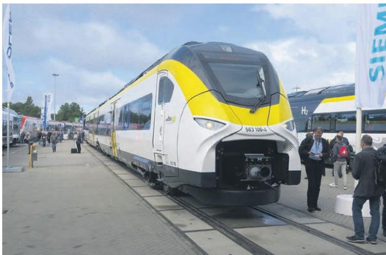
Der erste Triebwagen von SIEMENS, der mit Wasserstoff betrieben wird, soll während seiner Einsatzzeit etwa 15.000 CO<sub>2</sub> gegenüber einem Fahrzeug der gleichen Kapazität mit Dieselantrieb einsparen. Im Einsatz wird er 160 km/h schnell sein.
