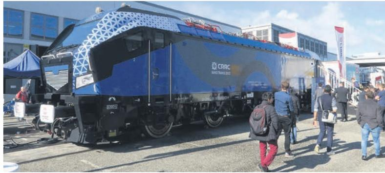
Auch im Eisenbahnsektor wird China in Europa aktiv. Die Ellok mit dem Namen Bison hat eine Leistung von 5.600 kW im Oberleitungsbetrieb und 200 kW im Last-Mile-Betrieb, welcher von den eingebauten Batterien übernommen wird und im Flachland für etwa zehn Kilometer reichen soll. Die Lok wird jetzt in Ungarn, Österreich und Deutschland während der nächsten Jahre getestet.
