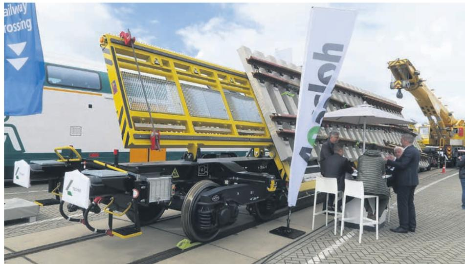
Dieser Transportwagen für montierte Weichen von Vossloh kann in Regelzügen mit einer Geschwindigkeit bis 100 km/h eingestellt werden.
