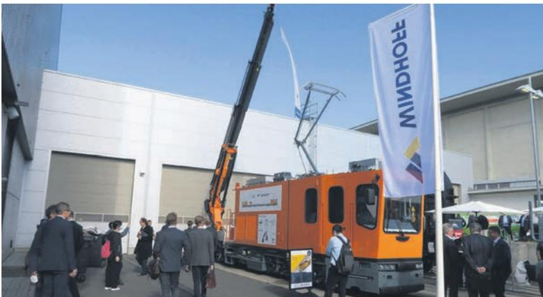
Die Firma Windhof ist spezialisiert auf Arbeits- und Rangierfahrzeuge. Dieses Fahrzeug ist für Straßenbahnbetriebe in Meterspur und Normalspur erhältlich.
