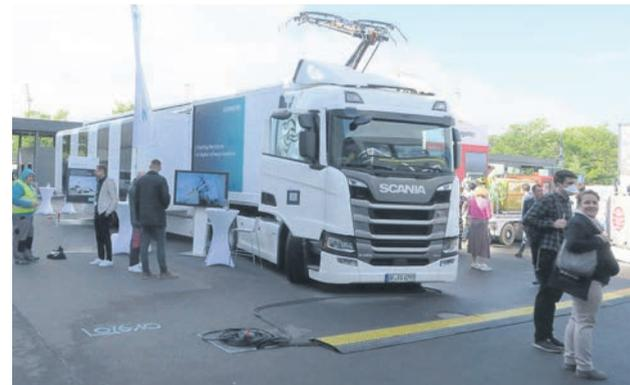
Lkw-Betrieb mit Oberleitung. Die Firma SIEMENS ist überzeugt davon, dass dieses System Zukunft haben und sich gegen den Wasserstoffantrieb durchsetzen wird, da in ihren Augen diese Energiequelle zu wertvoll ist, um sie im Straßenverkehr zu vergeuden.
