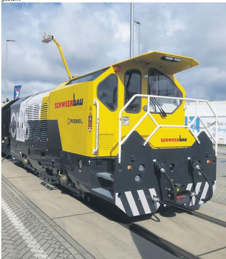
Zum Schleifen der Schienen im U-Bahnbereich, aber auch auf oberirdischen Tramstrecken mit einem Mindestradius von 50 m, gibt es diesen Schleifzug der Firma Robel. Der Antrieb erfolgt per Dieselmotor oder per Batterie. Je nach Arbeitsaufwand schafft der Zug zwischen 300 und 1.200 m/Stunde.
