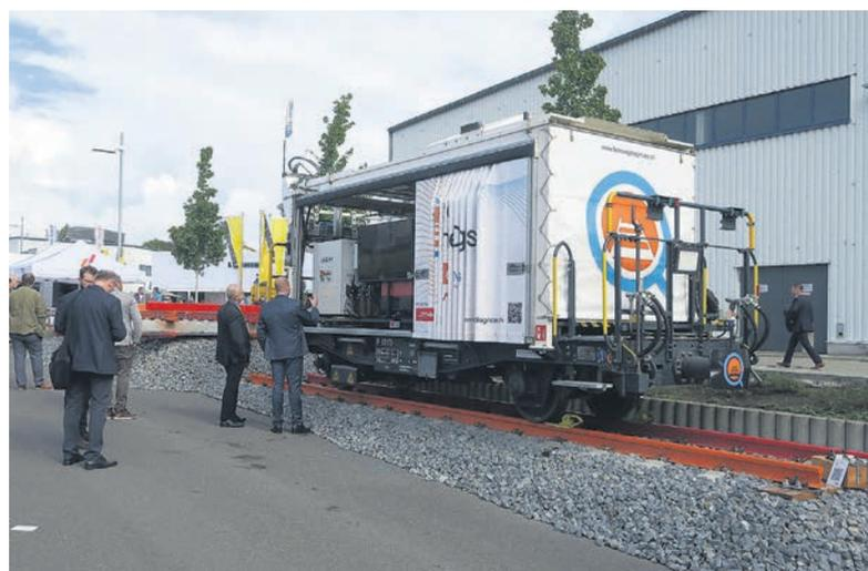
Dieser Wagen der Rhätischen Bahn kann an jeden Zug angehängt werden und sammelt so während der Fahrt Daten über den Zustand des Geistes.
