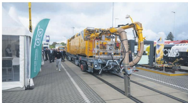
Dieser Staubsauger der Firma Robel sorgt für Sauberkeit im Gleisbereich. Die Reinigungsarbeiten erfolgen mit einer Geschwindigkeit von 2 km/h; überführt kann der Wagen mit 80 km/h werden.
