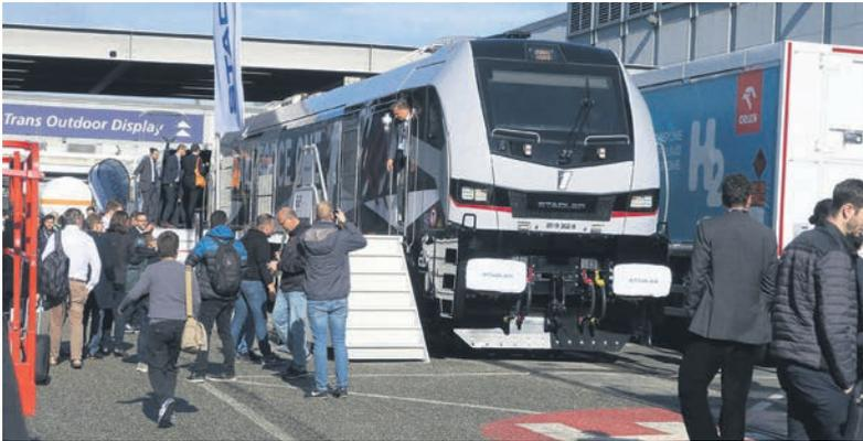
Die neue Dual-Lokomotive von Stadler ist mit einer Leistung von 9.000 kW unter Oberleitung und 2 x 950 kW im Dieselbetrieb ein richtiger Kraftprotz. Je nach Typ ist sie bis 160 km/h schnell und «verdaut» sämtliche geläufigen Oberleitungsspannungen.
