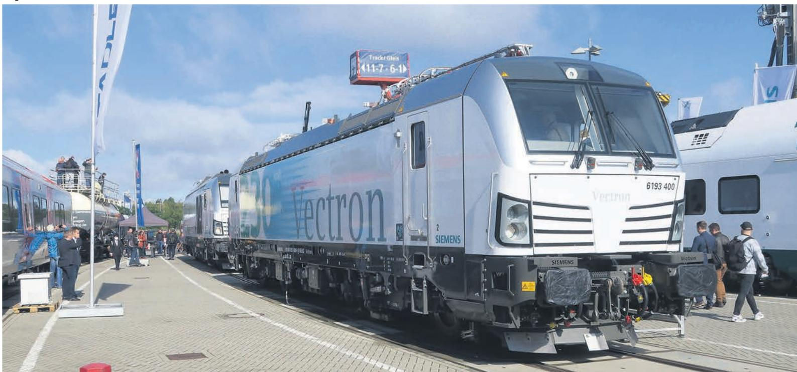
Auch die Siemens Elloks der Vectron-Familie gibt es als Vier-Stromloks, deren Einsatz nicht durch die unterschiedlichen Stromsysteme, sondern durch die unterschiedlichen Sicherheitseinrichtungen eingeschränkt ist.
