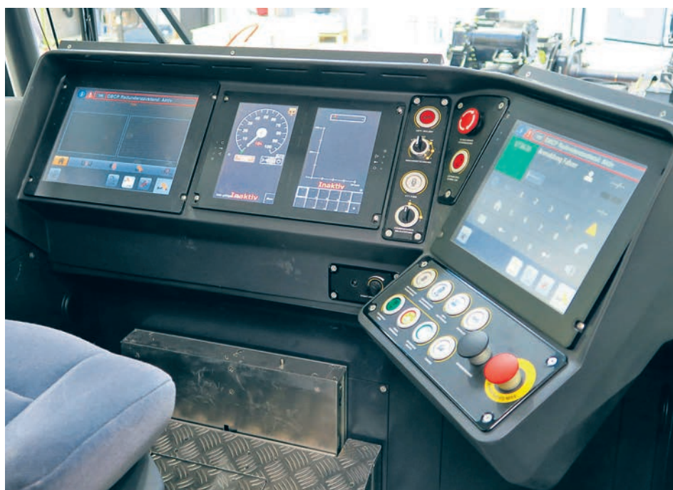
Der Führerstand eines Stadler-Triebwagens. In der Mitte befindet sich das Kontrollteil für den Betrieb, Tachometer mit Geschwindigkeitsbegrenzer links, rechts der Anzeiger über den zur Fahrt freigegebenen Streckenabschnitt.
