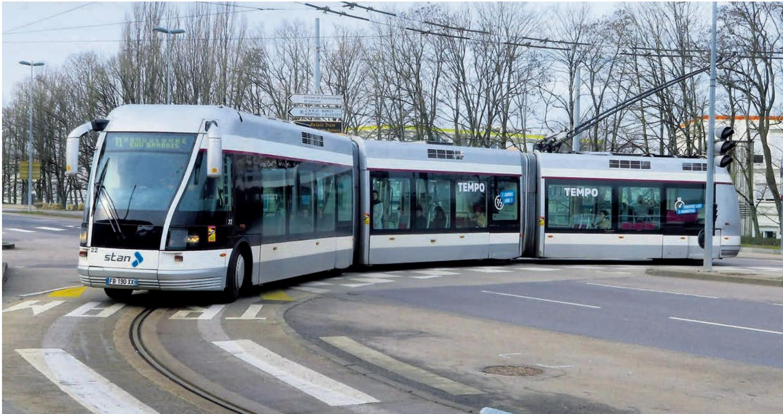
An der Haltestelle CHU Brabois wurde ein kurzes Stück Führungsschiene als Wendehilfe verlegt.
