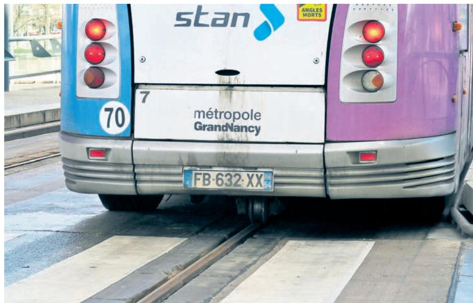
Das hintere Führungsrad des Busses in der Leitschiene.
