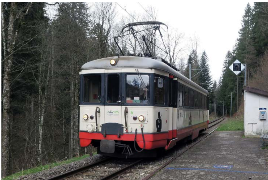
6) Zwischenhaltestelle Les Frtes. Das Signal ber dem Wartehuschen zeigt ein weies Blinklicht, welches dem Triebwagenfhrer zum Anhalten auffordert, wenn ein Reisender durch Drcken der Anschalttaste am Bahnsteig den Wunsch zum Einsteigen geuert hat.
