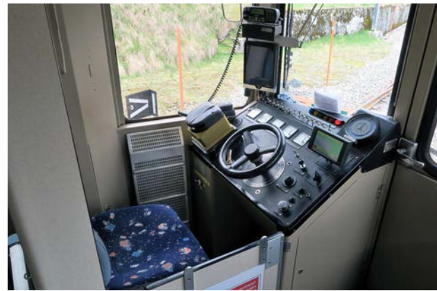
5) Der Fhrerstand des Triebwagens. Der/die Wagenfhrerin erhlt alle bentigten Informationen von der Leitstelle ber Tablet und den kleinen Monitor rechts vor dem Tachometer.
