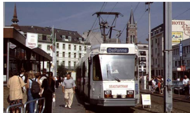
Wagen 6024 hier in Blankenberge trägt die neue weiße Lackierung von De Lijn und hat bereits seine Scharfenberg-Kupplung verloren; die Lampenanordnung und der Anzeiger entsprechen aber noch dem Originalzustand.
