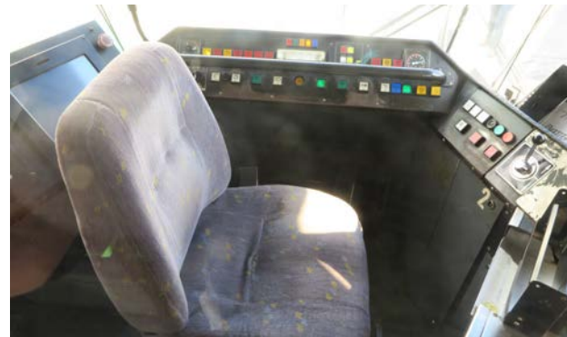
Der Führerstand eines BN-ACEC - Straßenbahnwagens: Beschleunigen und Bremsen erfolgt über die zwei rechten Fußpedale.
